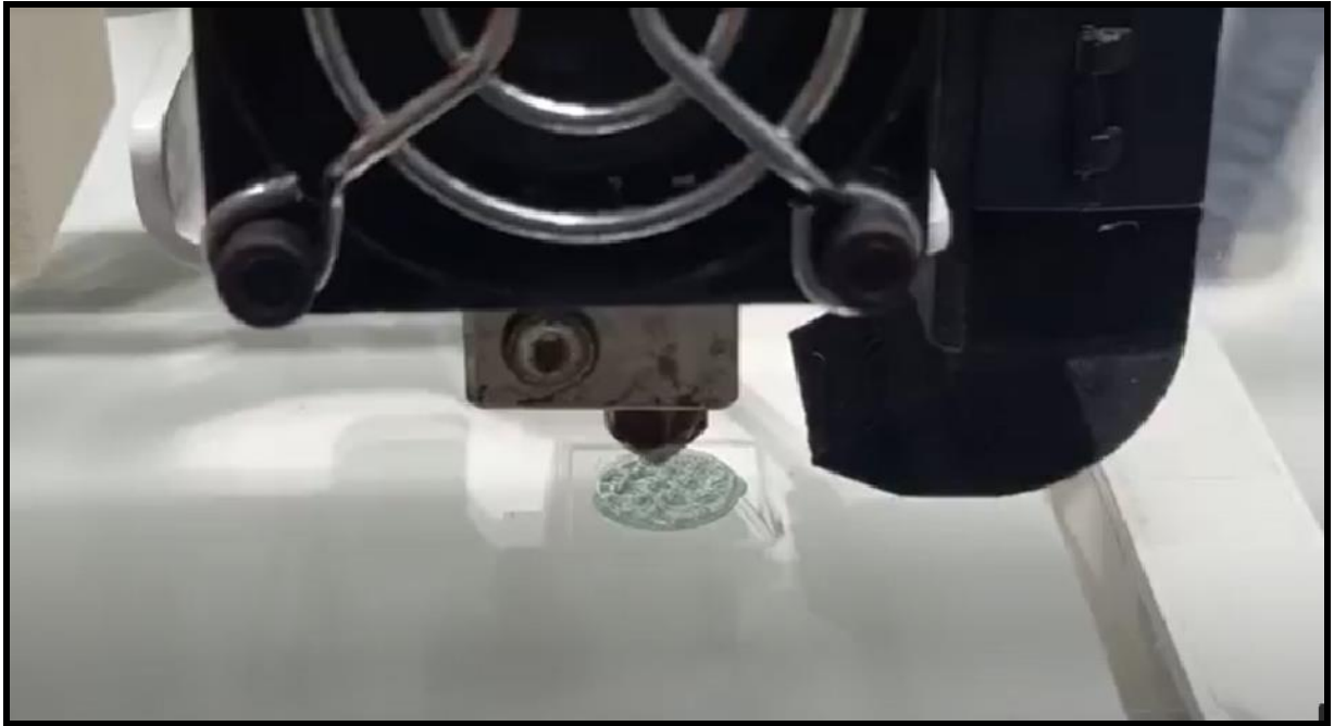
Figura 8. Construção dos arcaouços Fonte: Autora
