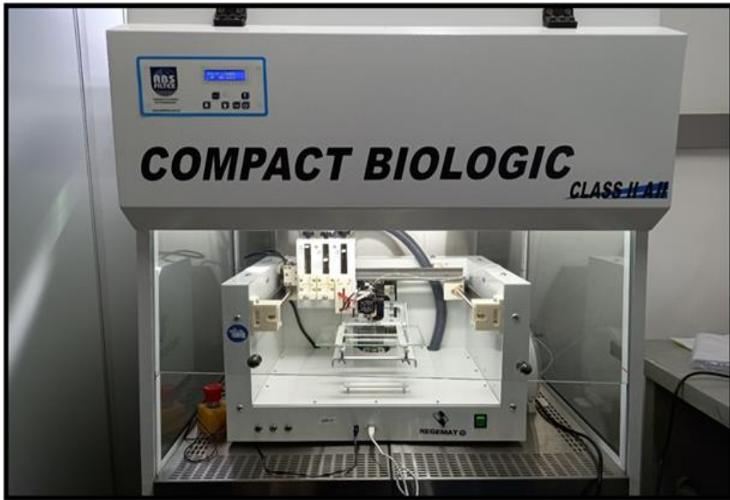
Figura 6. Bioimpressora por extrusão Fonte: Autora
