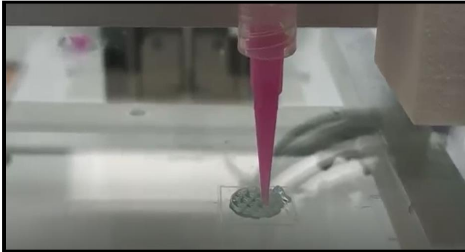
Figura 11. Deposição da cultura celular pela bioimpressora Fonte: Autora
