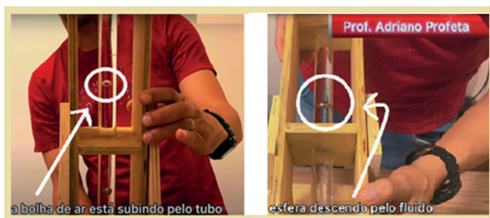
Figura 2. Dois instantes da prática de cinemática. À esquerda: a bolha de ar se deslocava para cima; à direita: a esfera de aço se deslocava para baixo.
