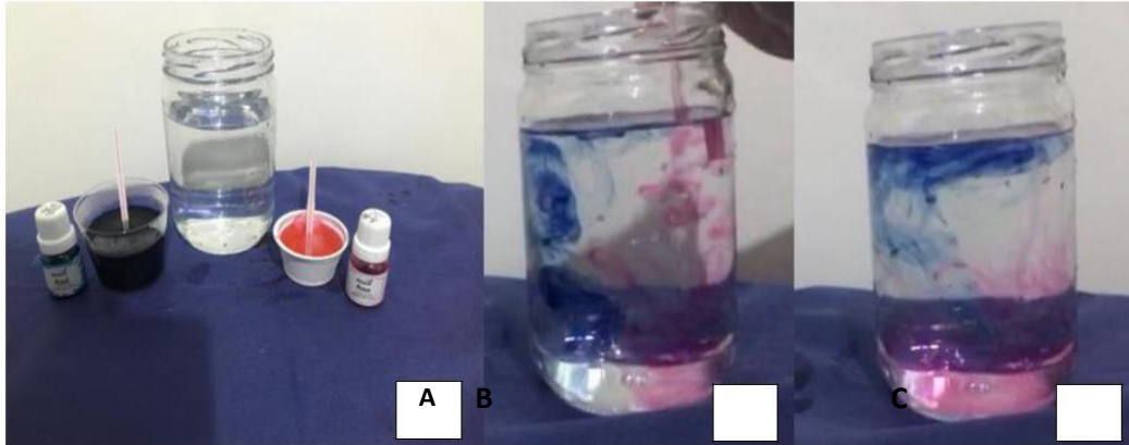
Figura 13: Experimento de corrente de convecção. A) Materiais necessários B) e C) Movimento de convecção.
