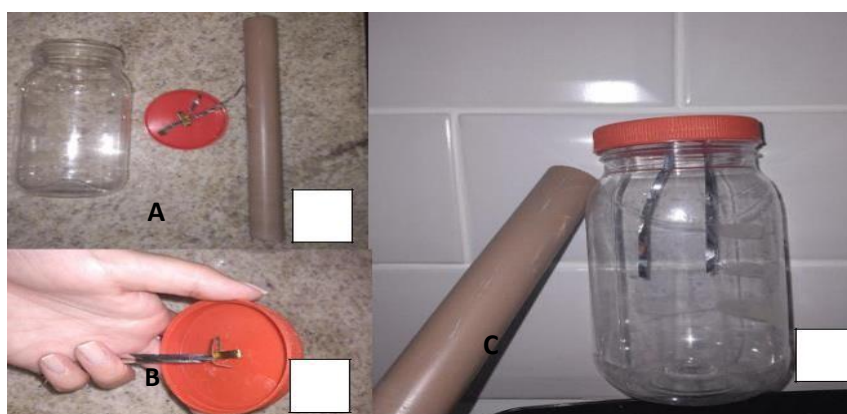
Figura 7: Experimento de Repulsão eletrostática. A) Materiais necessários. B) Detalhe da tampa furada. C) Tubo após ser atritado e os fios se repelindo.
