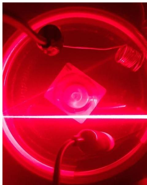
**FIGURA 37** - Presença de nanopartículas de cobre
