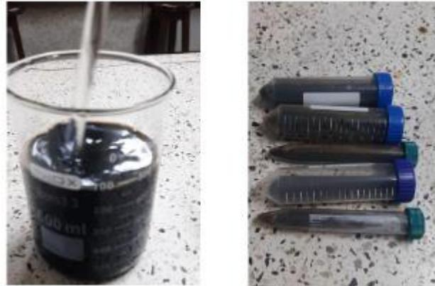
**FIGURA 42** - Resultado parcial da formação das nanopartículas magnéticas
