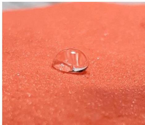
**FIGURA 31** - Formato da gota em uma superfície de areia, PVA cola e plástico
