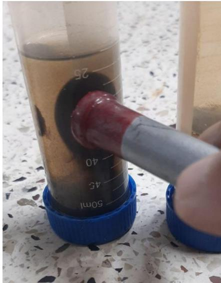
**FIGURA 43** - Resultado final das nanopartículas magnéticas interagindo com um ímã
