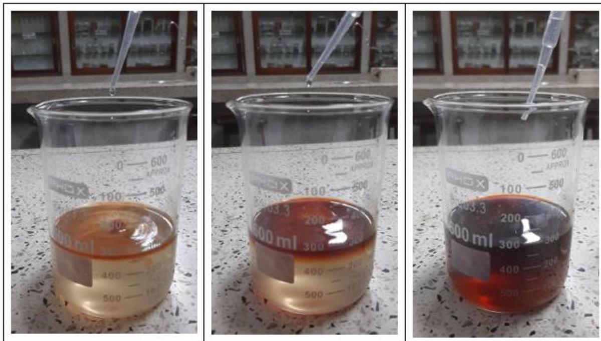
**FIGURA 40** - Reação de oxidação dos íons  $Fe^{2+}$  para íons  $Fe^{3+}$
