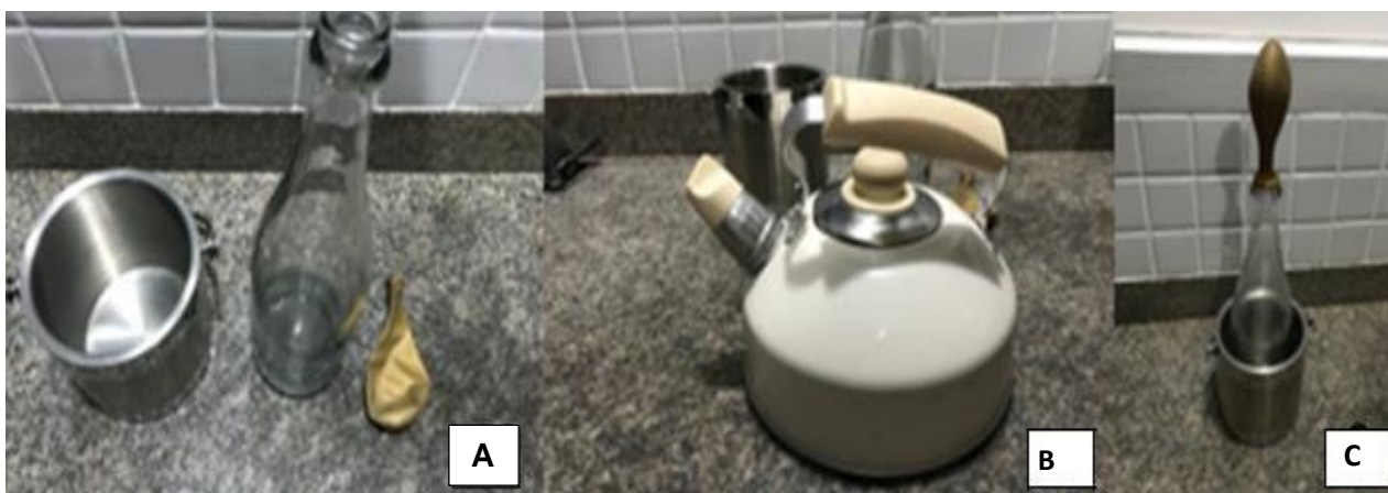
Figura 14: Experimento de expansão do ar quente. A) Materiais necessários. B) Chaleira com água quente. C) A expansão do ar.
